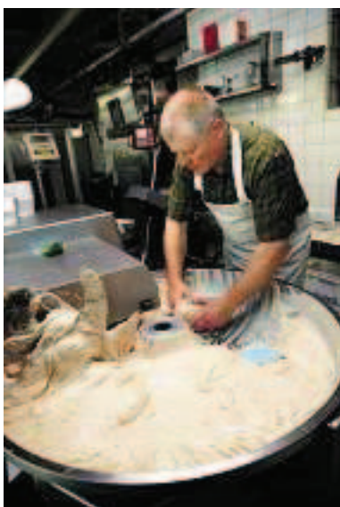
Das Fleisch wird im Cutter zu Brät verarbeitet und mit Gewürzen angereichert.
